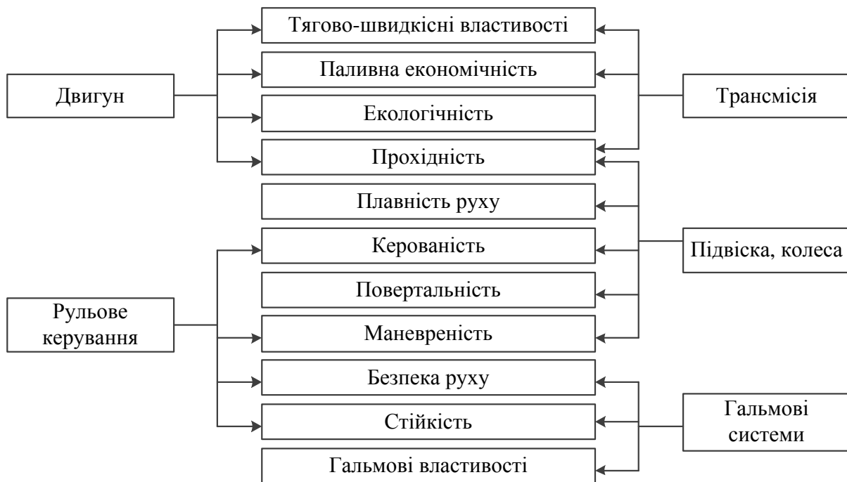
Рисунок 1.2 – Зв'язок експлуатаційних властивостей із системами і механізмами автомобіля
