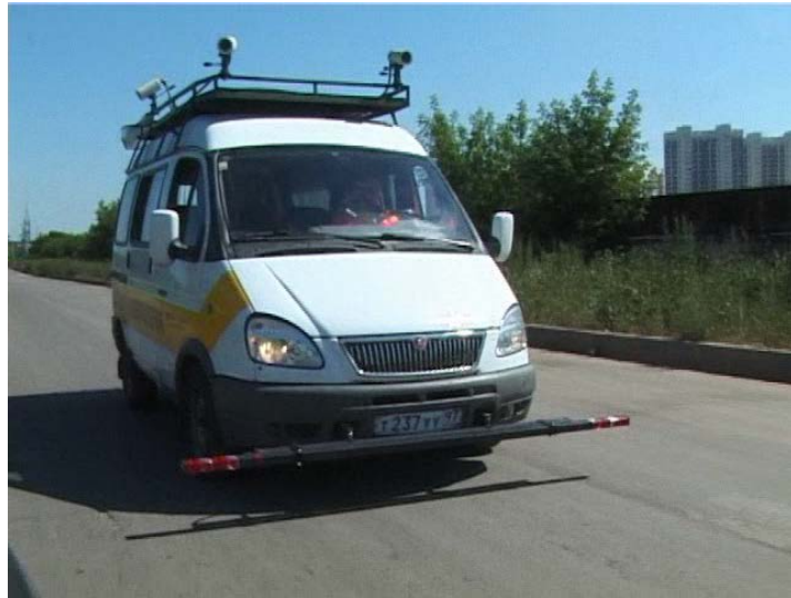
Рисунок 1.2 – Апаратно-програмний комплекс відеопаспортизації доріг
