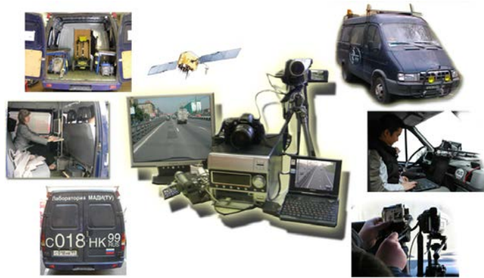
Рисунок 1.8 – Мобільна дорожня лабораторія «МУДРЕЦ» (основне обладнання)
