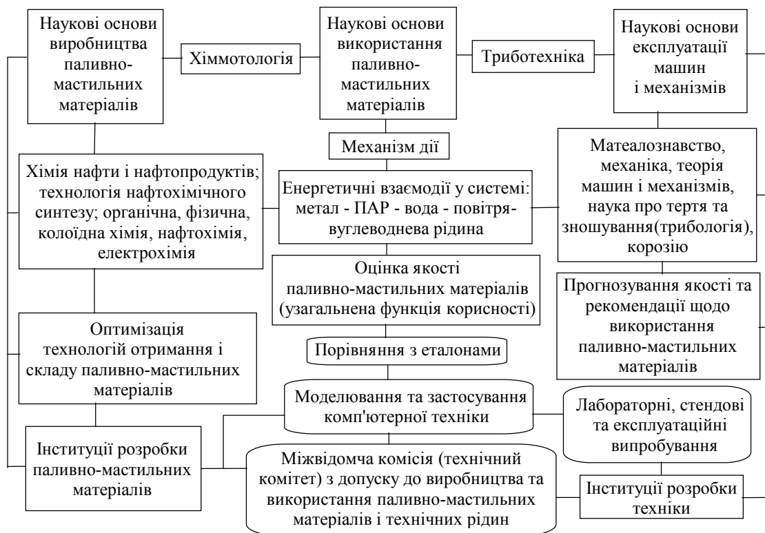
Рисунок 2 – Схема розробки, оцінки якості та використання паливно-мастильних матеріалів [3]
