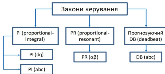
Рисунок 1.7 – Класифікація законів керування інверторами СЕС
