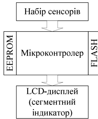
Рисунок 1.4 – Структура пристрою для діагностування барабанно-колодкового гальма
