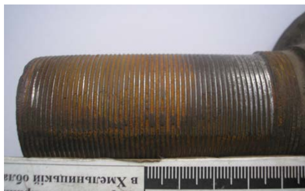
Рис. 2. Детальний вигляд пошкодження різьбової частини наконечника лівої штанги передньої підвіски автобуса «Ікарус»
