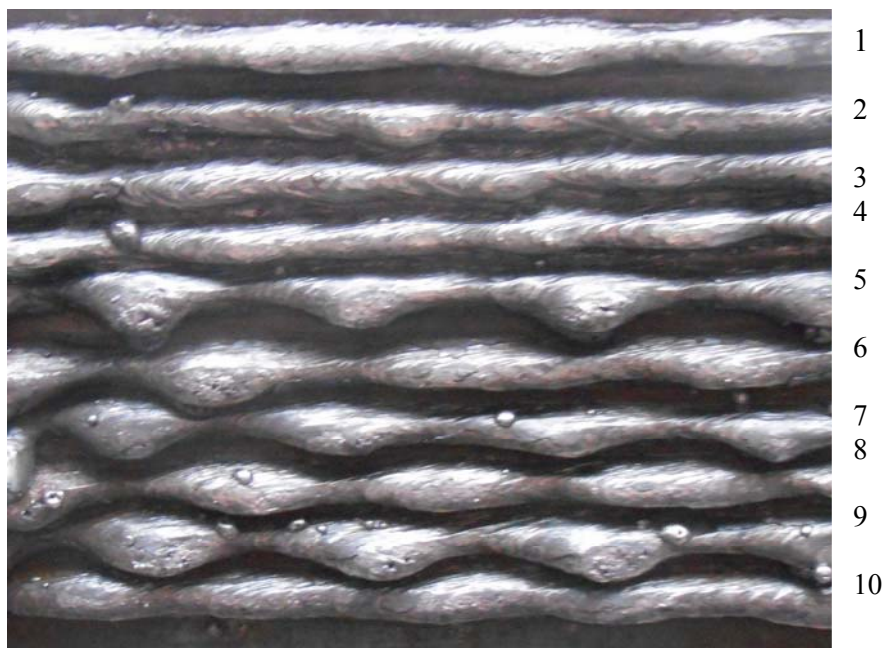
Рис. 1. Фрагменты валиков наплавленных в горизонтальном положении на вертикальной плоскости: 1,2,3,4,10 – использование дозированной подачи электродной проволоки; 5,6,7,8,9 – традиционный способ подачи
