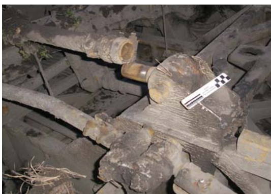
Рис. 1. Загальний вигляд пошкодження елементів передньої підвіски автобуса «Ікарус»
