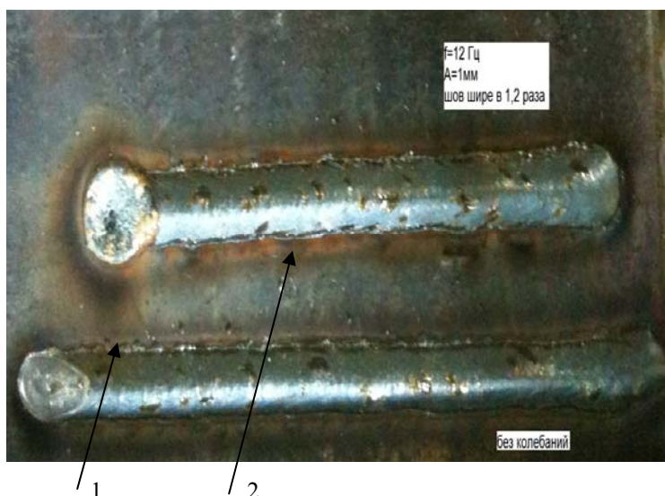
Рис. 6. Результати порівняльної наплавки: 1 – без колибаний; 2 – з колибаннями
