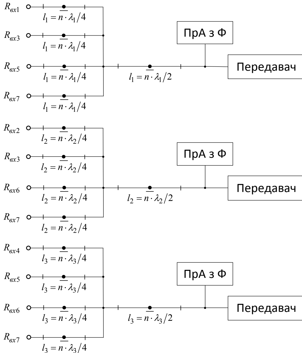
Рисунок 6.20 – Структурна схема пасивного радіочастотного транспондера з моноімітансним шифратором
