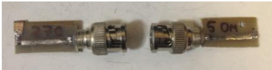
Рисунок 5.18 – Вхідні опори номіналами 270 Ом (логічна «1») і 5 Ом (логічний «0»)
