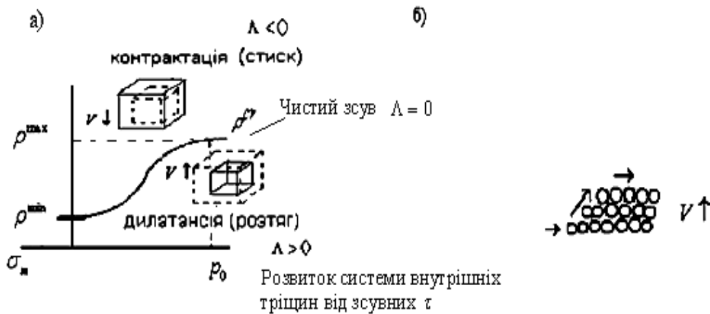
Рисунок 1.7 – Межі зміни щільності ґрунту залежно від величини гідростатичного тиску \sigma_m (а) та процес прийняття більш відкритої упаковки при зсуві щільних ґрунтів (б)
