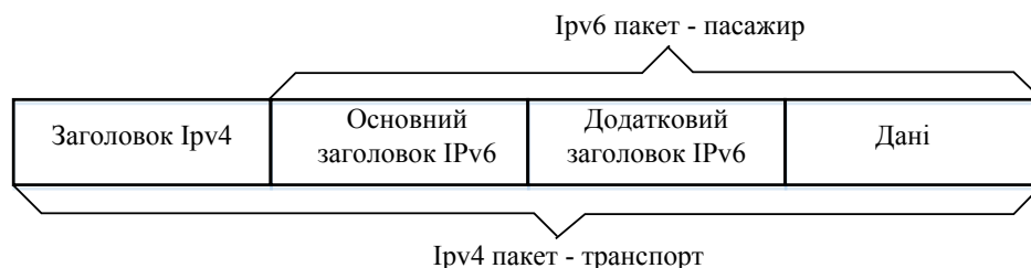
Рисунок 4.26 – Інкапсуляція IPv6 пакета в пакет IPv4
