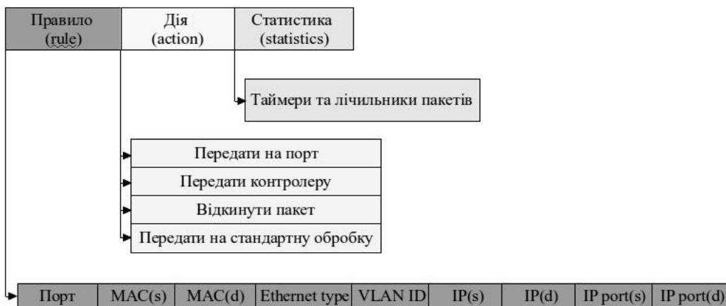
Рисунок 7.16 – Елементи таблиці потоків комутатора OpenFlow
