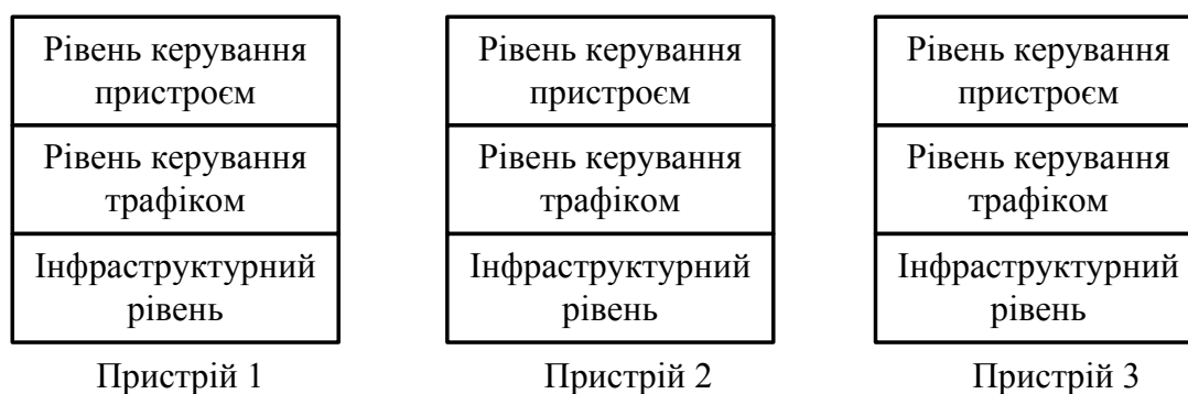
Рисунок 7.12 – Модель стандартної архітектури сучасних мережних пристроїв
