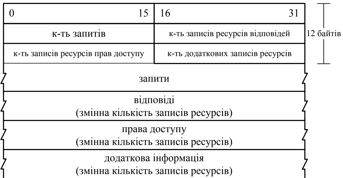
Рисунок 6.5 – Формат DNS повідомлення
