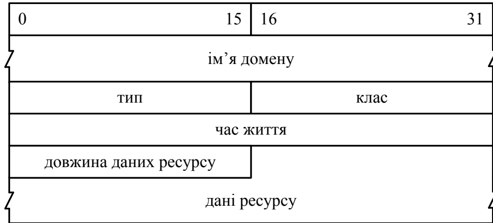
Рисунок 6.9 – Загальний формат запису ресурсу
