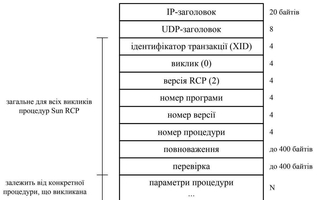
Рисунок 6.15 – Повідомлення виклику процедури RPC у форматі UDP-дейтаграми
