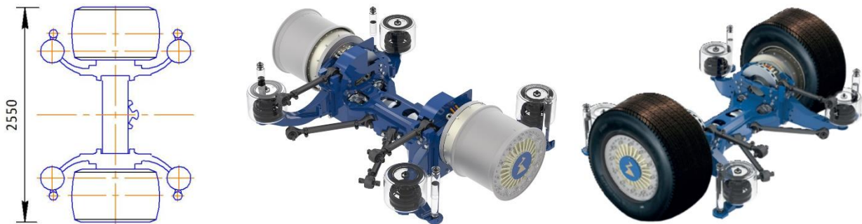
Рисунок 2 – Портальний міст інтегрально-балкового типу "ZAwheel SM 530" (електричний) німецької фірми "Ziehl-abegg SE" зі спеціальними шинами типорозміру 455/45 R22,5 [4]
