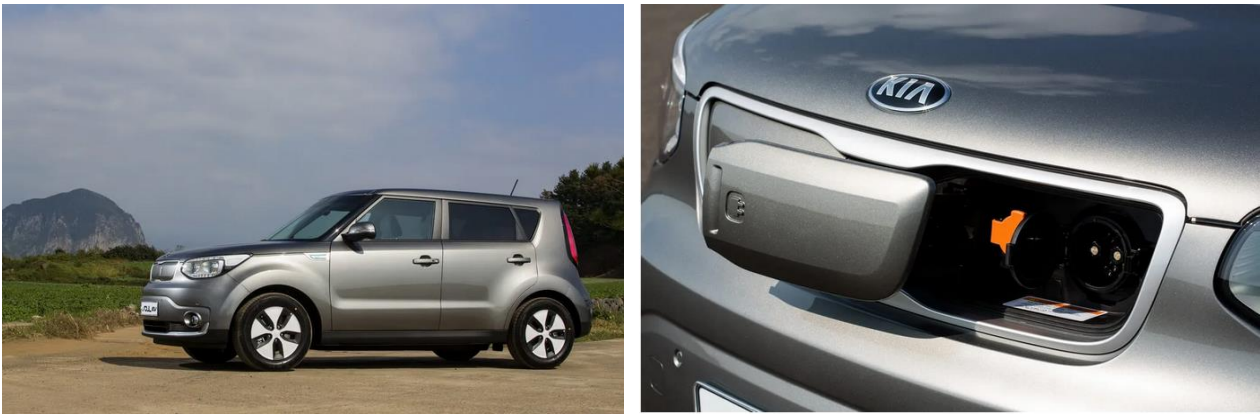
Рисунок 3 – Kia Soul EV - перший електромобіль південнокорейського концерну KIA (а). Роз'єм підключення електромобіля Kia Soul до зарядки (б) [14]
