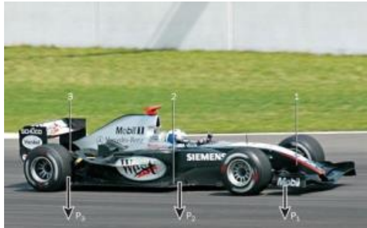
Рисунок 2 – Аеродинамічні елементи на гоночному автомобілі
