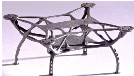
Рис. 2 – Литий каркас для міні-дрона за 3D друківаною моделлю
