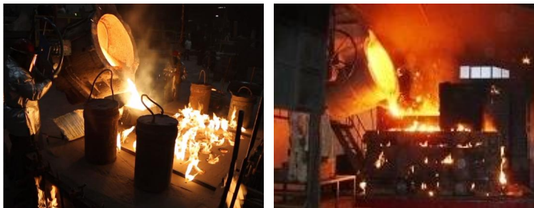
Рис. 2 – Горіння газу на формі від газифікації моделі.
