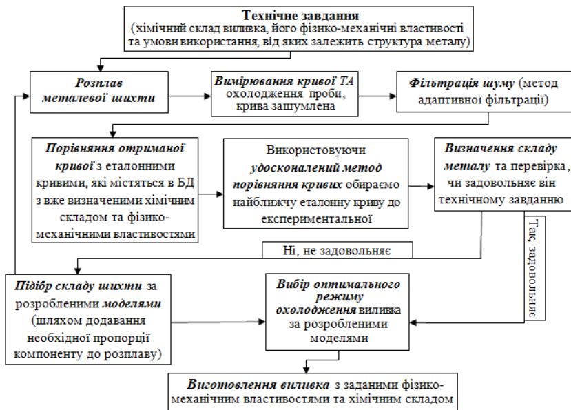
Рис. 1 – Схема корегування складу металу, його структури та властивостей виливка за результатами програмної обробки результатів термоаналізу (ТА) [2].
