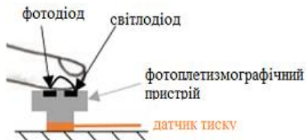
Рис.1. Принцип роботи системи вимірювання тиску
