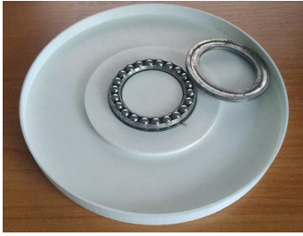
Рис. 1. Обертова платформа, що виготовлена методом 3D друку
