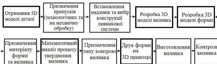
Рисунок 3 – Схема розробки ливарного процесу з 3D друком ливарної форми.
