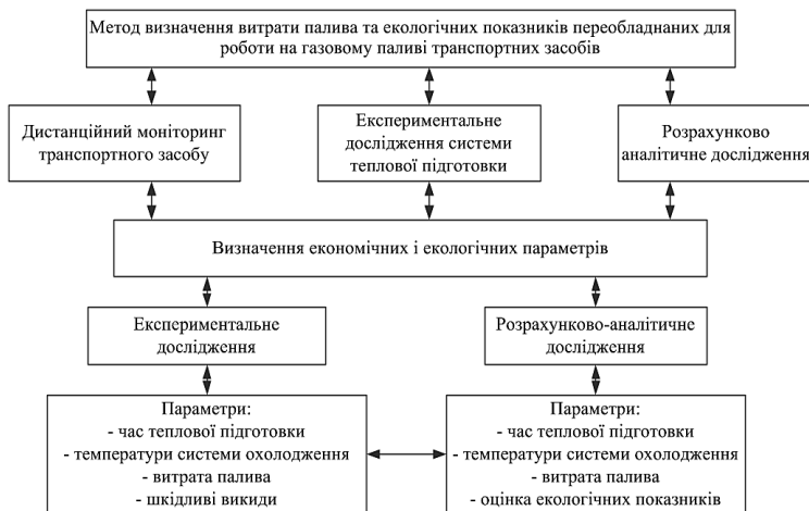
Рисунок 1 – Функціональна схема реалізації методу визначення витрати палива та екологічних показників транспортних засобів працюючих на газовому паливі
