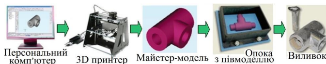
Рис. 2 – Схема виробництва ливарних моделей і виливків з технологією швидкого прототипування [3].
