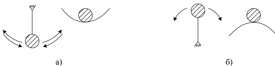
Рисунок 2.1 – Стійкі (а) та нестійкі (б) стани механічної системи
