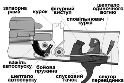
Рисунок 1 - Ударно-спусковий механізм автомата Калашникова
