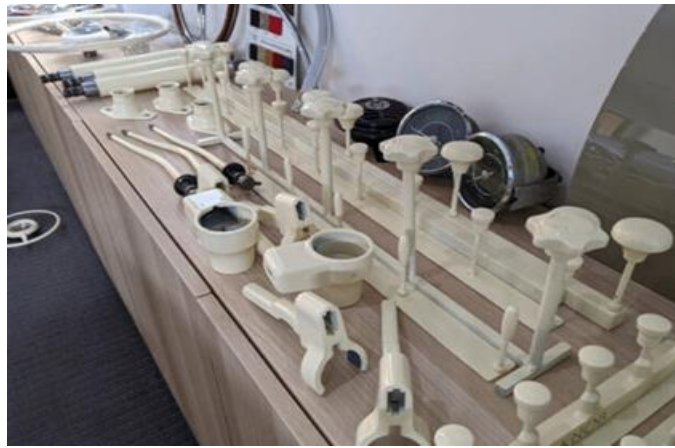
Рисунок 3 – Після фарбування 3D-друкарські ручки та корпуси індикаторів дуже схожі на оригінальні [19].
