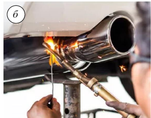
Рисунок 3 – Приклад проведення зварювальних робіт на СТО: зварювання кузова (а); зварювання випускної системи (б) [8]
