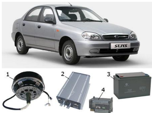
Рисунок 1 – Загальний вид автомобіля, який переобладнують та компоненти: 1 – мотор – колесо; 2 – перетворювач; 3 – акумуляторна батарея; 4 – контролер
