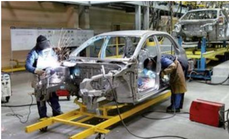
Рисунок 2 – Зварювальні роботи під час виготовлення автомобіля [8]
