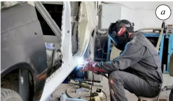
Рисунок 3 – Приклад проведення зварювальних робіт на СТО: зварювання кузова (а); зварювання випускної системи (б) [8]
