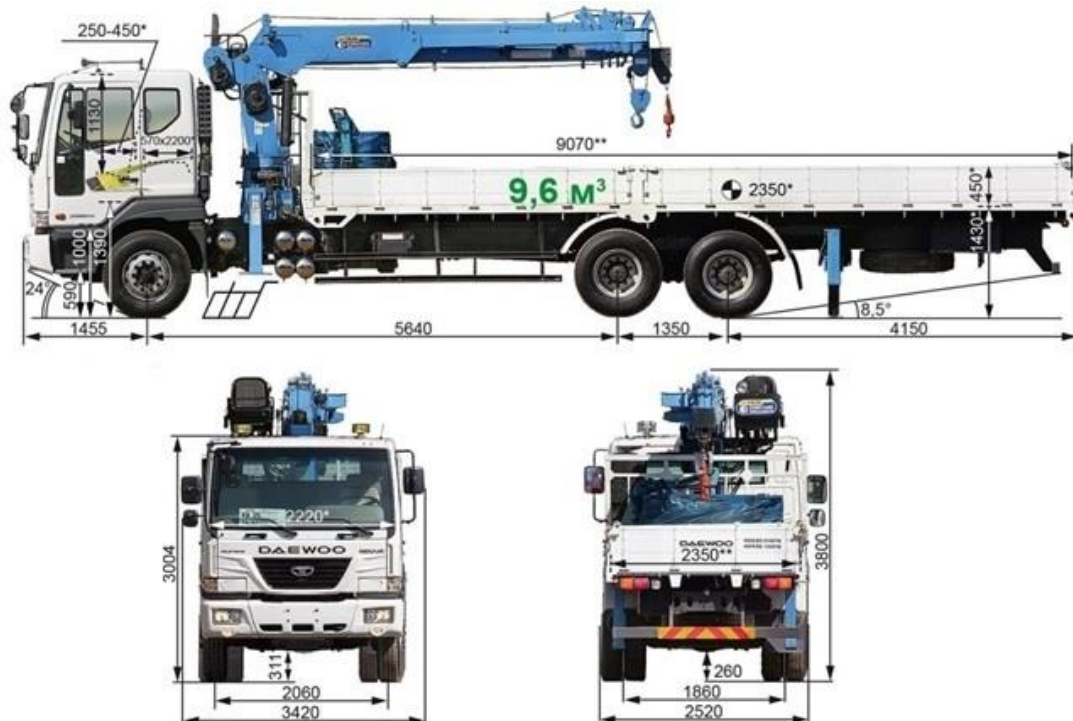
Рисунок 6 – Вантажний автомобіль Daewoo Novus оснащених кран-маніпулятором
