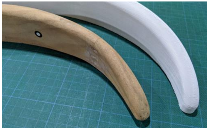
Рисунок 4 – Оригінальний дерев'яний компонент 1956 року та 3D-друкований компонент ASA [19].
