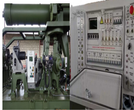
Рис.7. Механізм вертикального наведення та апаратура стартової автоматики ПУ
