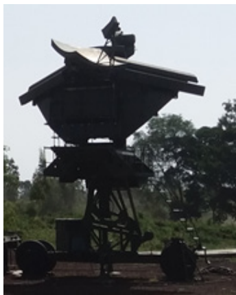
Рис.3. Модернізований антенний пост УНВ-MRz.
