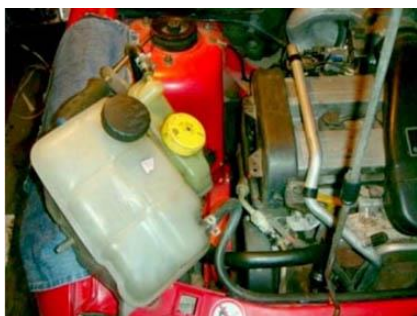
Рисунок 1 – Зняття бачків із рідиною.
