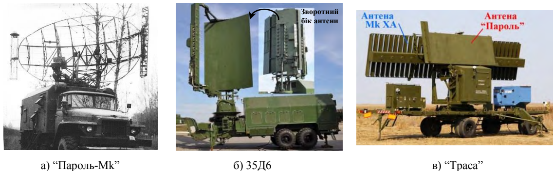
Рисунок 2 – Можливі варіанти побудови комплексованих НРЗ.
