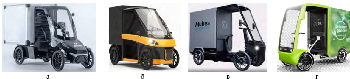
Рис. 1. Велоелектромобілі капотного типу (а) та вагонного типу (б, в, г): а) – "Citkar"; б) – "CityQ"; в) – "Mubea"; г) – "EAV eCargo"
