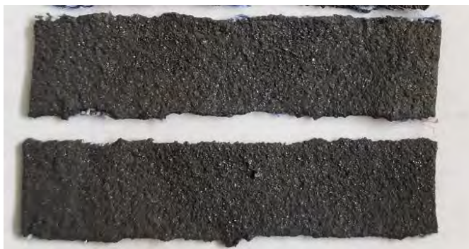
Рисунок 1 – Приклад гнучкої електродної стрічки
