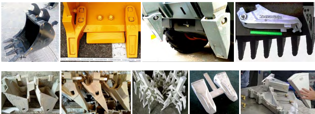
Рисунок 1 – Приклади литих робочих органів землерийної техніки (верхній ряд) та їх пінополістирольних моделей для ЛДМ (нижній ряд)
