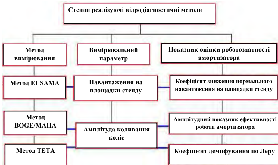
Рисунок 1.2 - Класифікаційна схема методів контролю технічного стану амортизаторів на вібростендах
