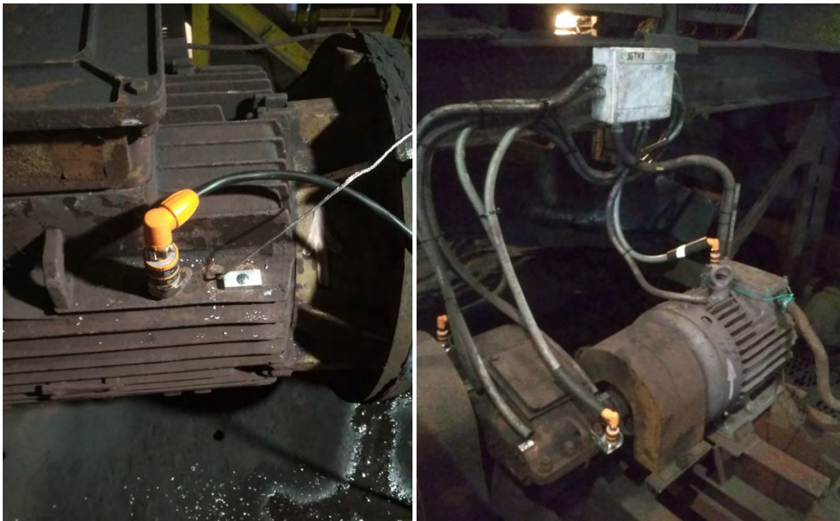
Рис. 1. Встановлення датчика вібрації на механізмах
