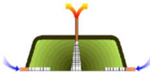
Рисунок 1.4 – Схема конвективної аерації буртів при компостуванні
