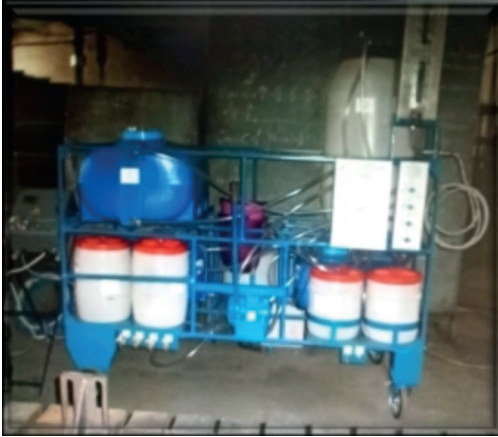
Кавітаційна установка виготовлення різних емульсій
