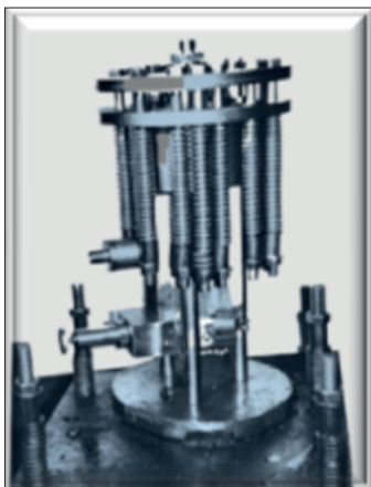
Експериментальна вібротрамбівка з гідроімпульсним приводом
