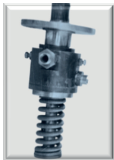
Силовий гідромеханізм гідроперфоратора
