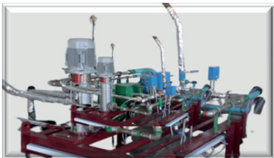
Кавітаційна установка для виготовлення бітумних емульсій
