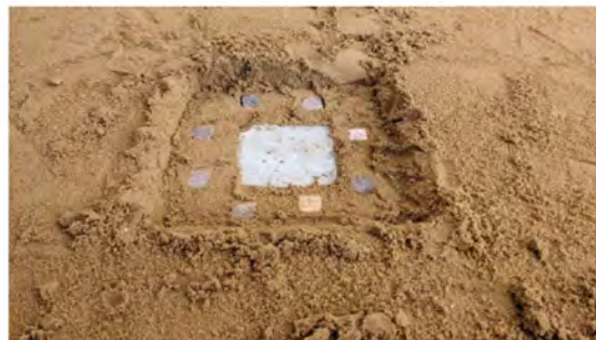
Рис. 5 – Розміщення паль підсилення
