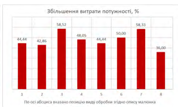
Рисунок 2 – Покращення продуктивності а) та збільшення витрати потужності б) для шпинделя 1,5 кВт на фрезерно-гравірувальному верстаті з ЧПК в порівнянні із роботою цього верстата з шпинделем 0,3 Вт
