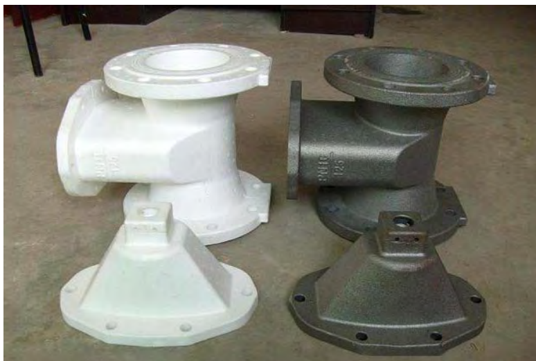
Рисунок 1 - Модель з пінополістиролу та металева заготовка отримана методом ЛГМ
