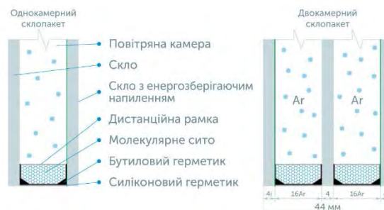
Рис. 5. Детальний опис будови енергоефективного склопакета
