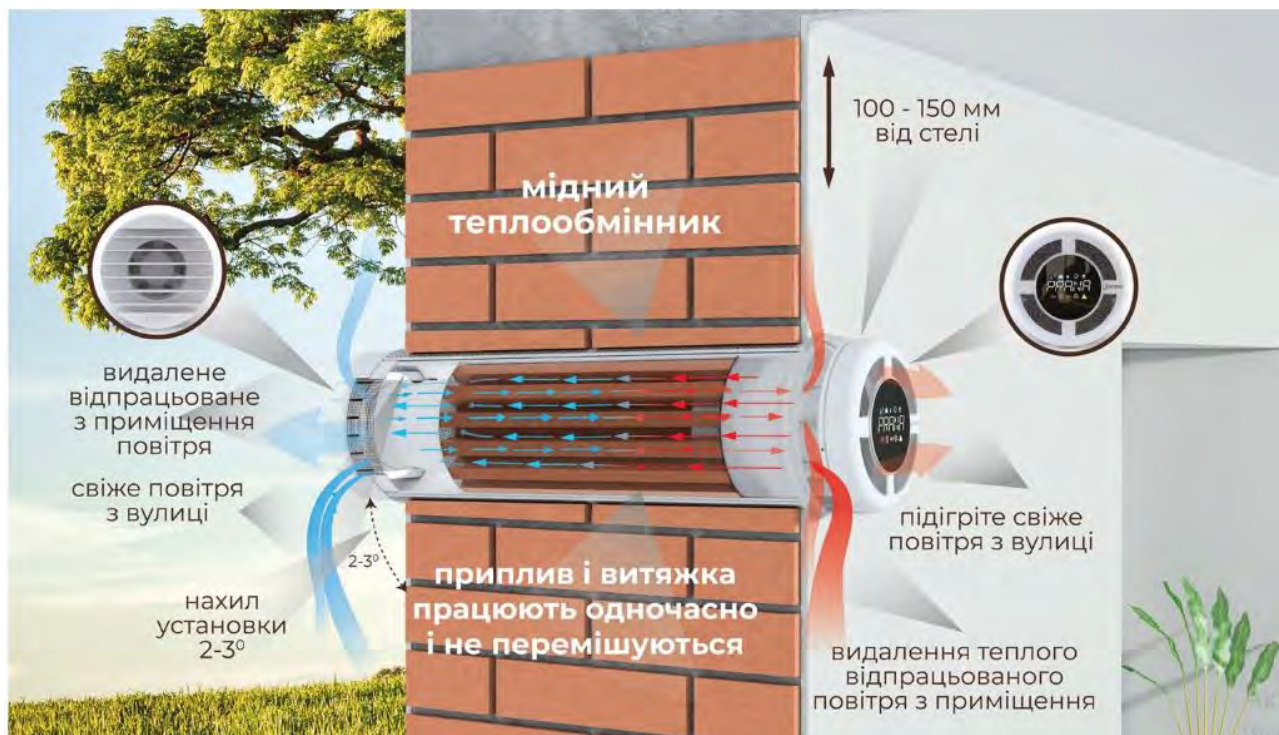
Рис. 1 – Схема роботи системи вентиляції із мідним теплообмінником [1, 2]
