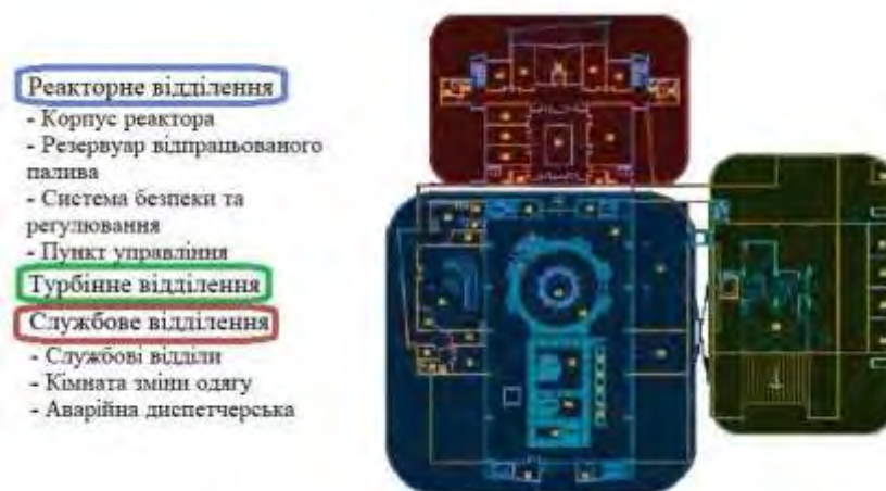
Рисунок 2 - Розташування станції CAREM
