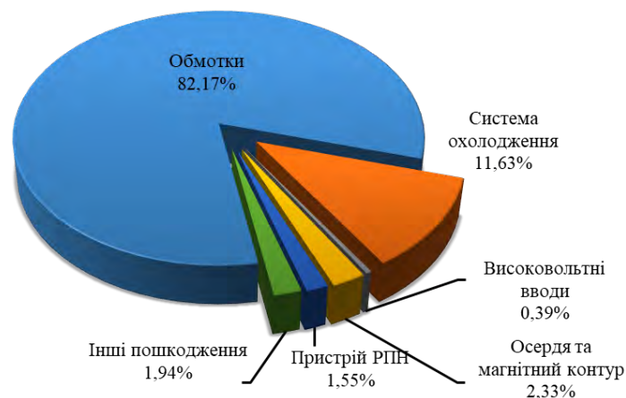
Рис. 1. Причини пошкоджень силових трансформаторів
