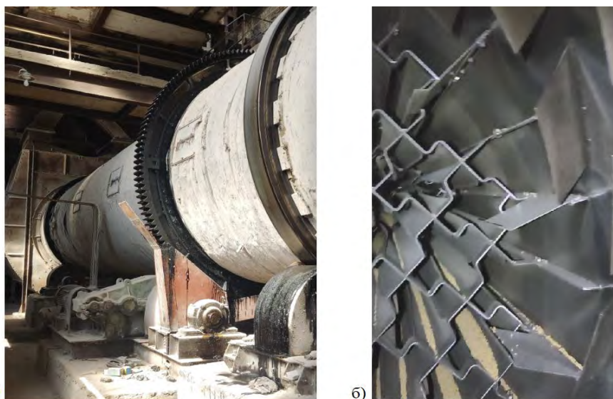
Рис. 1. Барабанна сушарка для сушіння бурякового жому: а) зовнішній вигляд; б) вигляд з середини
