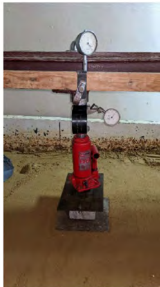
Рис. 6 – Модель фундаменту, підсиленого банкетом зверху, перед випробуванням
