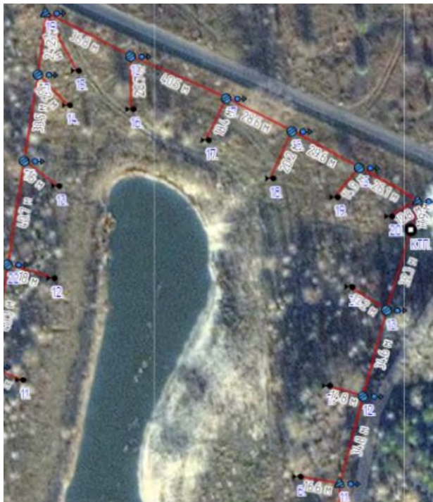
Рисунок 2 – Побудова траси ПЛІ в програмі SiCAD
