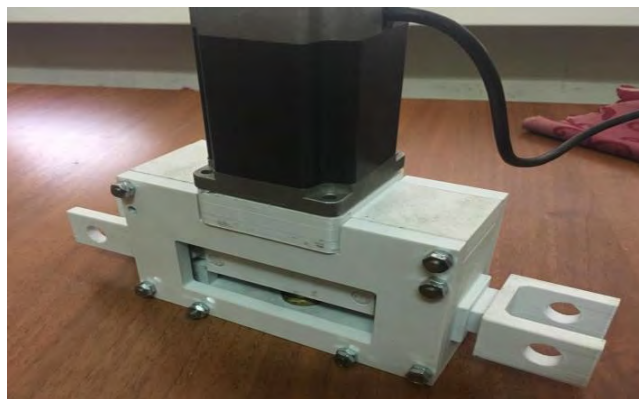
Рис. 4. Модель механізму корегування кутів встановлення керованих коліс
