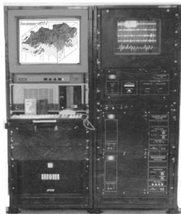
Рис. 4. Універсальна система збору та реєстрації даних сейсмозвідки "ІНТРОМАРИН - 240"
