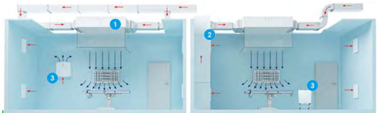
Рис. 1 – Схема роботи системи вентиляції приміщення лікарні [1, 2]
