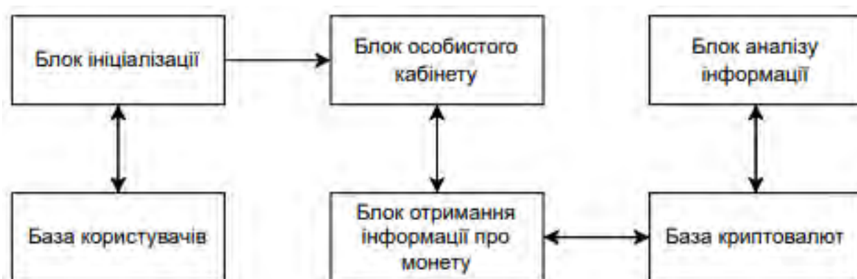
Рисунок 1 – Структурна схема взаємодій складових інтелектуального модуля оцінювання ризиків при інвестуванні в криптовалюту
