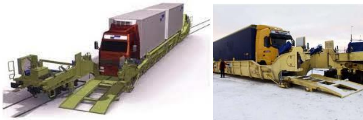
Рисунок 1 – Зображення контрейлерного перевезення за системою Flexiwaggon
