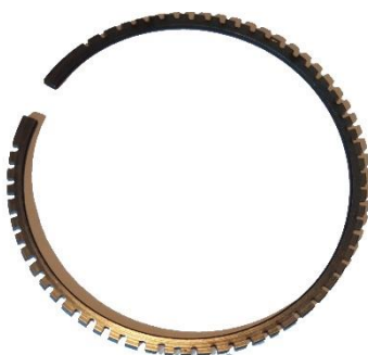
Рисунок 1 – Конструкція контртіла при проведенні дослідження зношування пари тертя «гільза – кільце».
