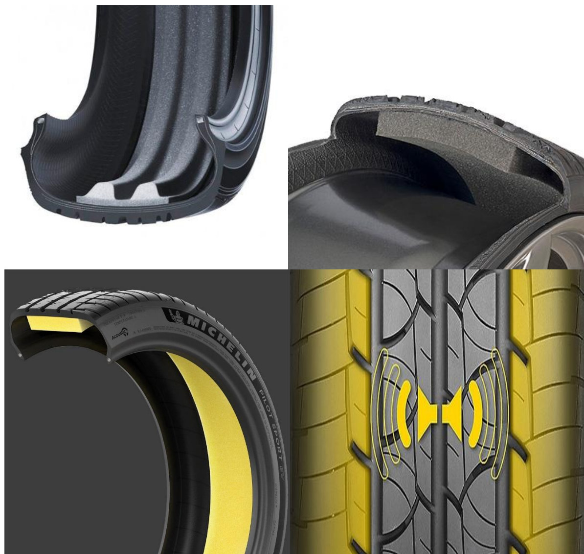
Рисунок 1 – Візуалізація конструктивних особливостей фрагментів малошумних шин.
