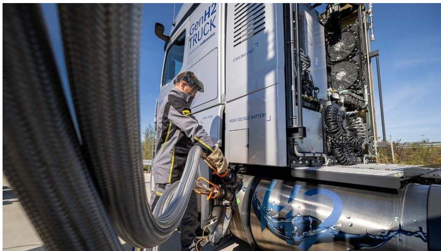
Рисунок 2 – Заправлення вантажівки Mercedes-Benz GenH2 рідким воднем
