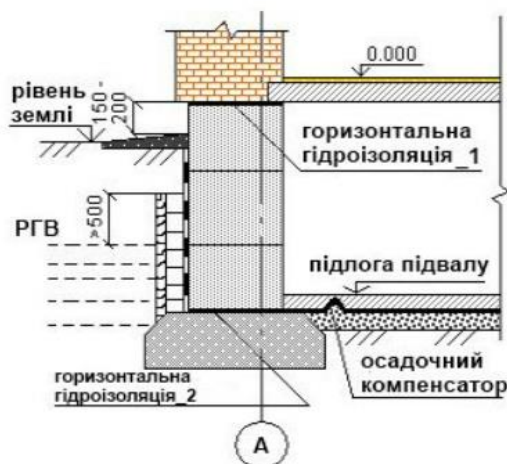
Рис.1. Гідроізоляція підвалу при високому рівні ґрунтових вод
