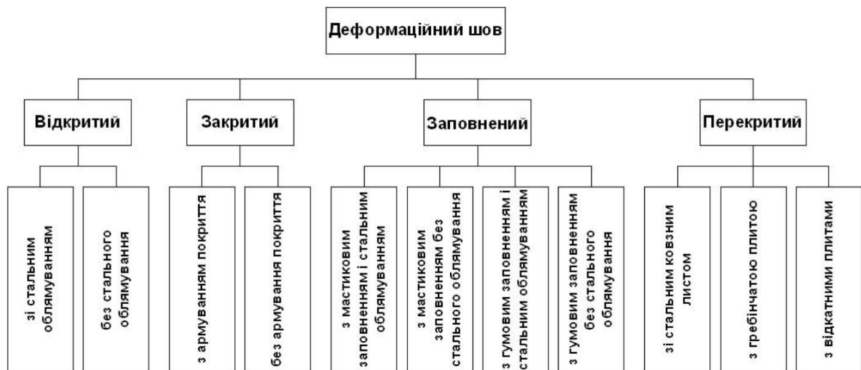
Рис. 1. Класифікація конструкцій деформаційних швів автодорожніх мостів [3]
