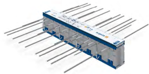
Рис. 3. Спосіб подолання мостиків холоду стику балконної плити встановленням несучої термовставки на прикладі закладного елемента Schock Isokorb® Type K для суцільних консольних балконів [4, с. 6]
