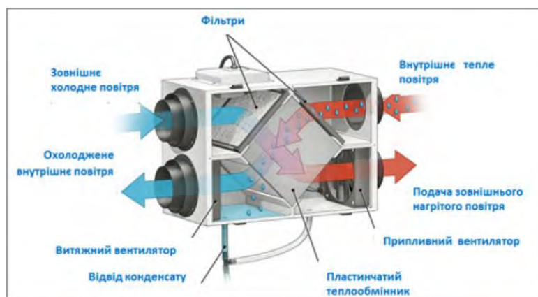
Рис. 2 – Принципова схема теплоутилізатора витяжного повітря системи вентиляції [4]
