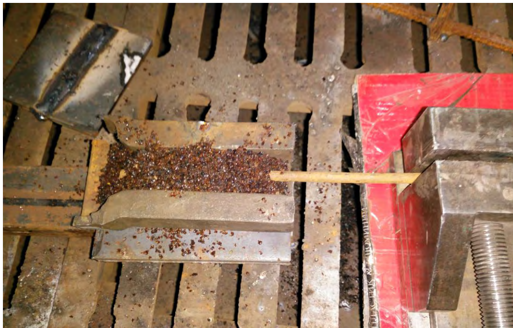
Рис.1. Наплавлення лежачим електродом під шаром флюсу
