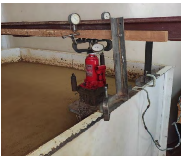
Рис. 3 – Система для передавання навантаження на моделі фундаменту
