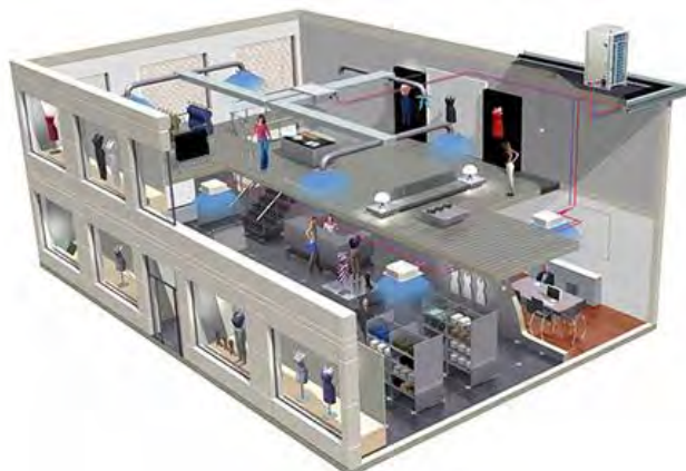
Рис. 1 – Схема влаштування системи вентиляції громадської будівлі
