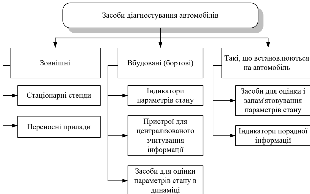
Рис. 2 – Класифікація засобів технічного діагностування за технологічним розташуванням [2]
