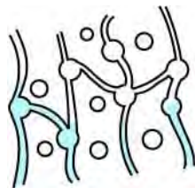
Рисунок 2 – Всмоктування рідини в капілярно-пористу структуру бетону
