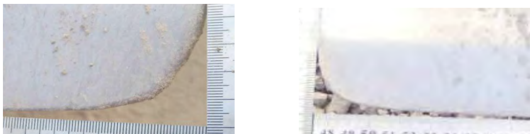
Рисунок 1 – Знос правого та лівого кінців ножа бульдозера
