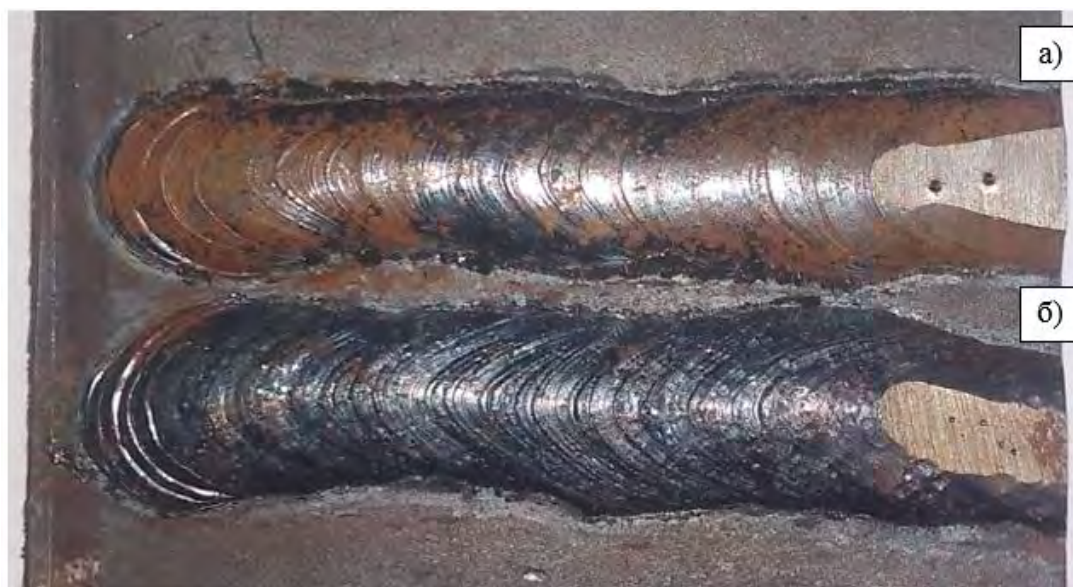
Рис. 2. Вимірювання твердості напавлених швів: а – напавлення лежачим електродом під шаром флюсу; б - напавлення лежачим електродом під шаром суміші флюсу і вуглецю.
