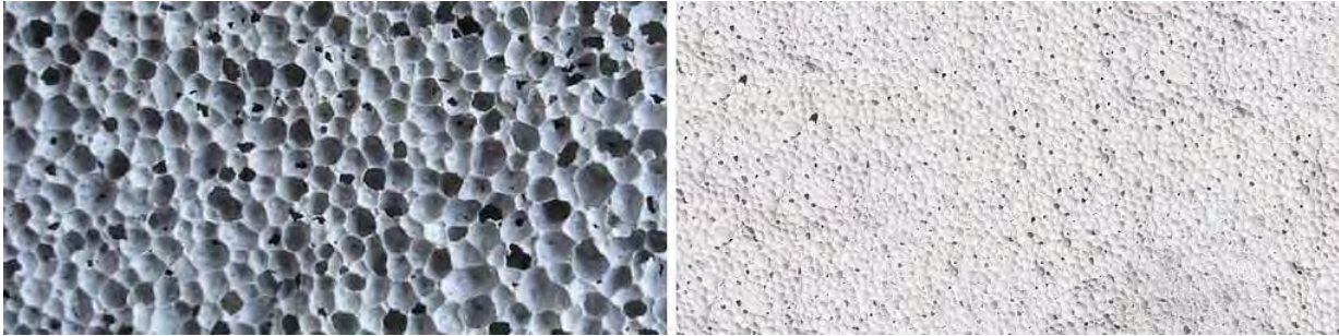
Рис.3. Структура піно- та газобетонних блоків
