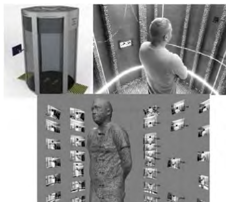
Рисунок 1 – Панорамний тривимірний сканер
