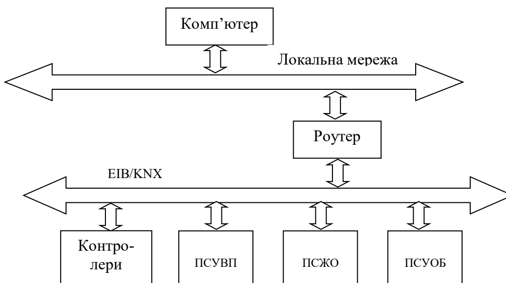
Рис.2 Структурна схема розроблюваної АСУЖ «Розумний будинок»
