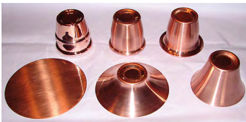
Рис. 1. Етапи формоутворення деталей, що виготовляються ротаційною витяжкою
