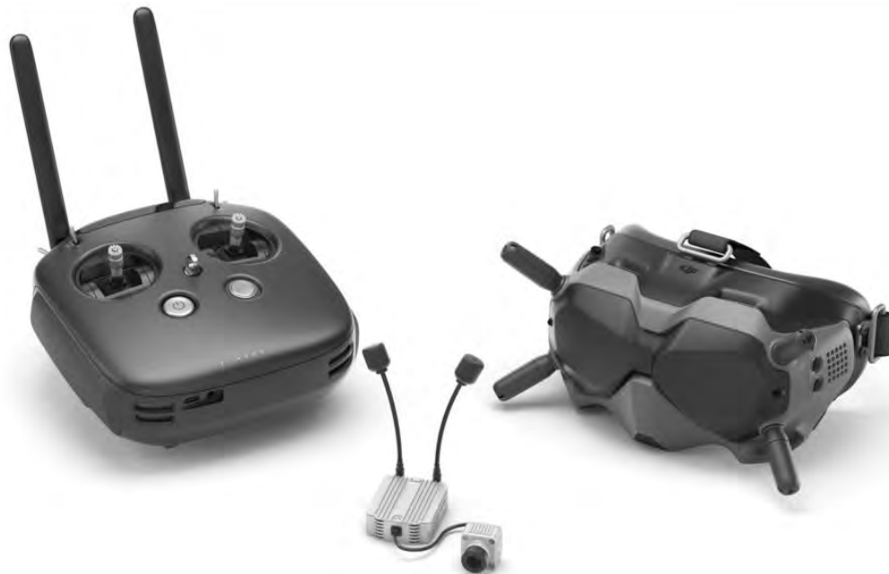
Рисунок 3 - цифрова система керування дронами FPV від виробника DJI
