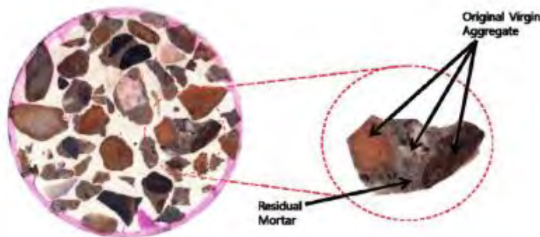
Рис. 2. Бетон з щебнем із бетонного брухту
