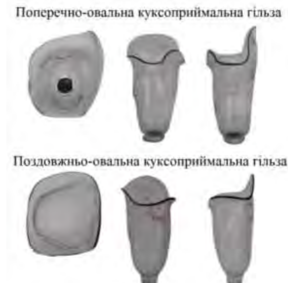
Рис. 5. Різновиди конструкції куксоприймальної гільзи при трансфemorальній ампутації
