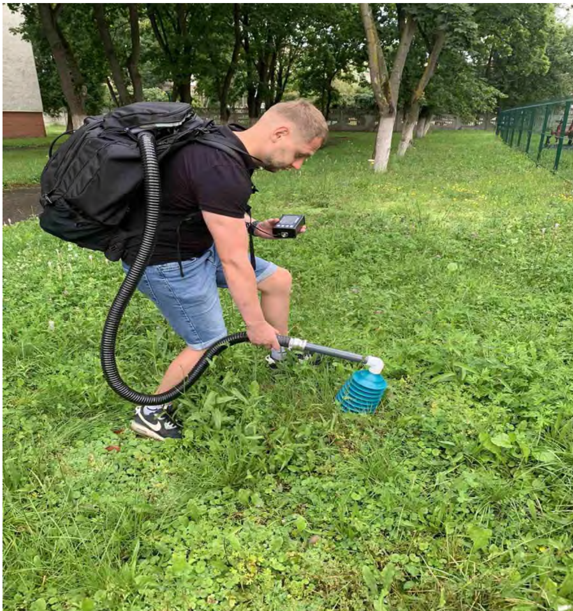
Рис. 2. Визначення місць розгерметизації газопроводів
