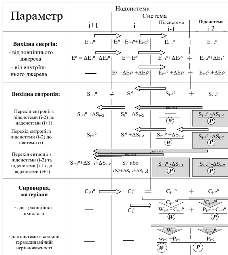
Рис.2 – Умови для створення принципу термодинамічної двоєдності, як механізму утворення промислових відходів у виробничих системах
