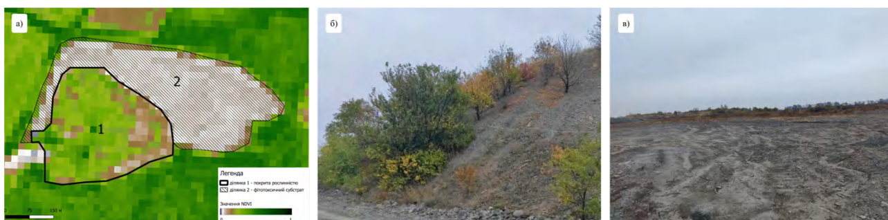
Рис. 2. А) візуалізація відвалу шахти на основі індексу рослинності NDVI. Б) ділянка 1- частина відвалу з рослинним покривом. В) ділянка 2 - частина без рослинного покриву
