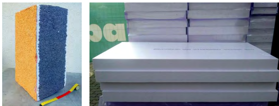
Рис.1. Пінопластові утеплювачі фасадних стін: ліворуч – з екструдованого полістиролу; праворуч – у вигляді конструктивних елементів товщиною 160 мм з уступами висотою 80 мм по периметру
