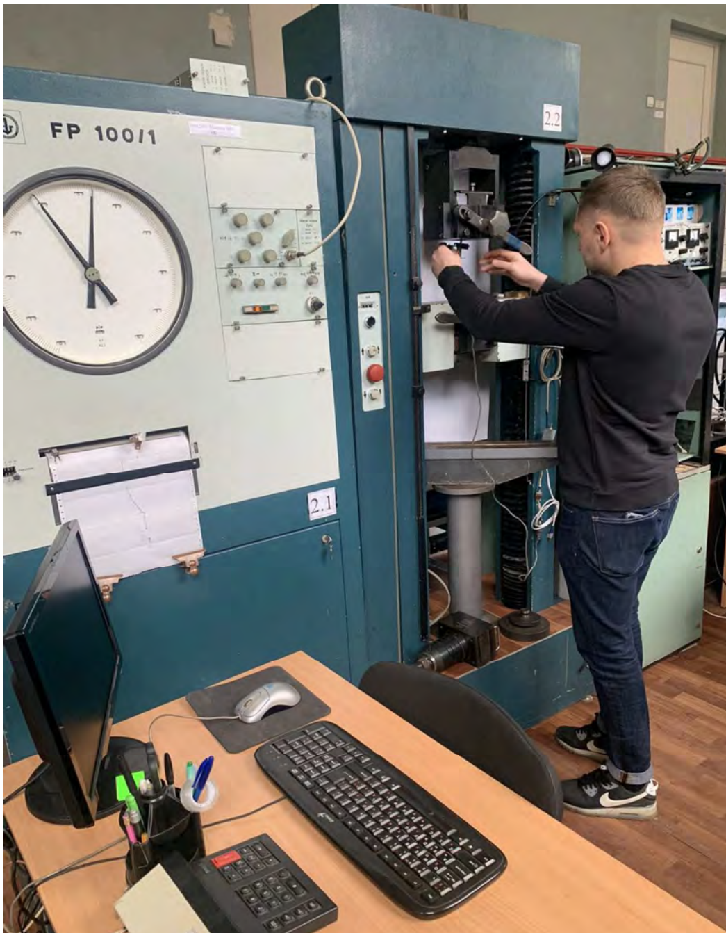
Рис.1. Проведення експериментальних досліджень на втомну міцність
