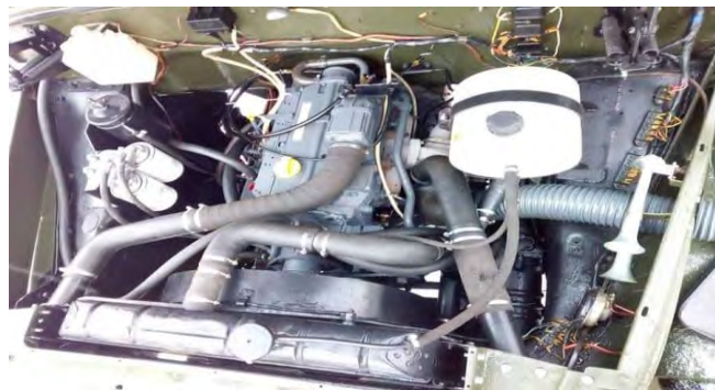
Рисунок 1 – Приклад переобладнання СУ ЗР ЗІЛ-131Н з карбюраторного ДВЗ на дизельний на ДП “45-й ЕМЗ” (м. Вінниця)
