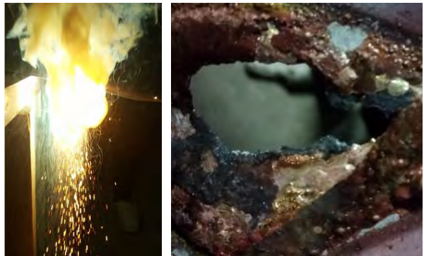
Рис 2. Процес та результат проплавлення металу
