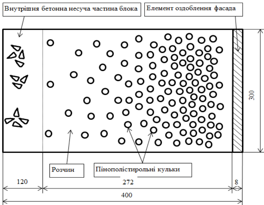
Рисунок 1 – Конструкція високотехнологічного термоблока
