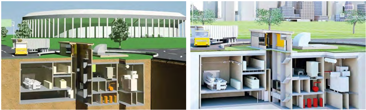
Рис. 1. Фрагмент монтажу підземної трансформаторної підстанції [6].
