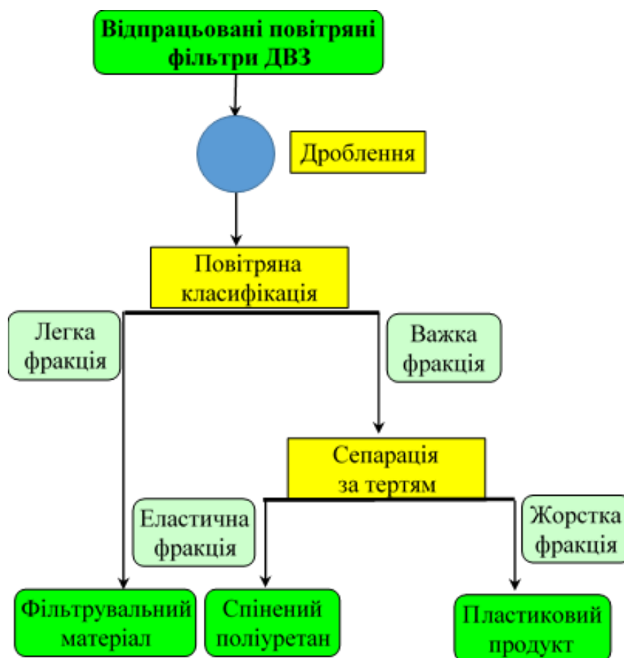
Рисунок 2 – Технологічна схема переробки повітряних фільтрів автомобілів
