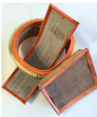
Рисунок 1 – Фото відпрацьованих повітряних фільтрів
