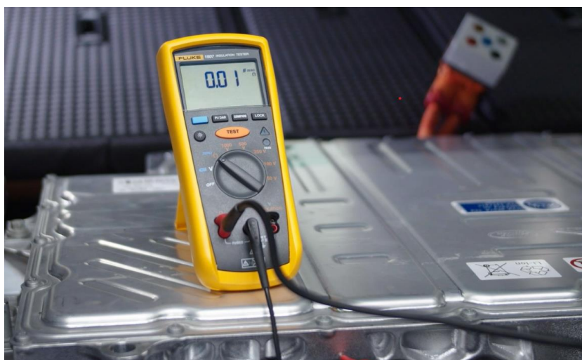
Рисунок 3 – Перевірка системи вирівнювання потенціалів за допомогою Fluke 1507
