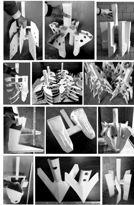
Рисунок 4. Приклади ливарних моделей металовиробів навісного ґрунтообробного та землерийного обладнання
