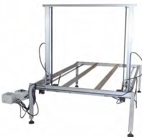
Рис. 1 - Конструкція дровіх верстатів з числовим програмним керуванням
