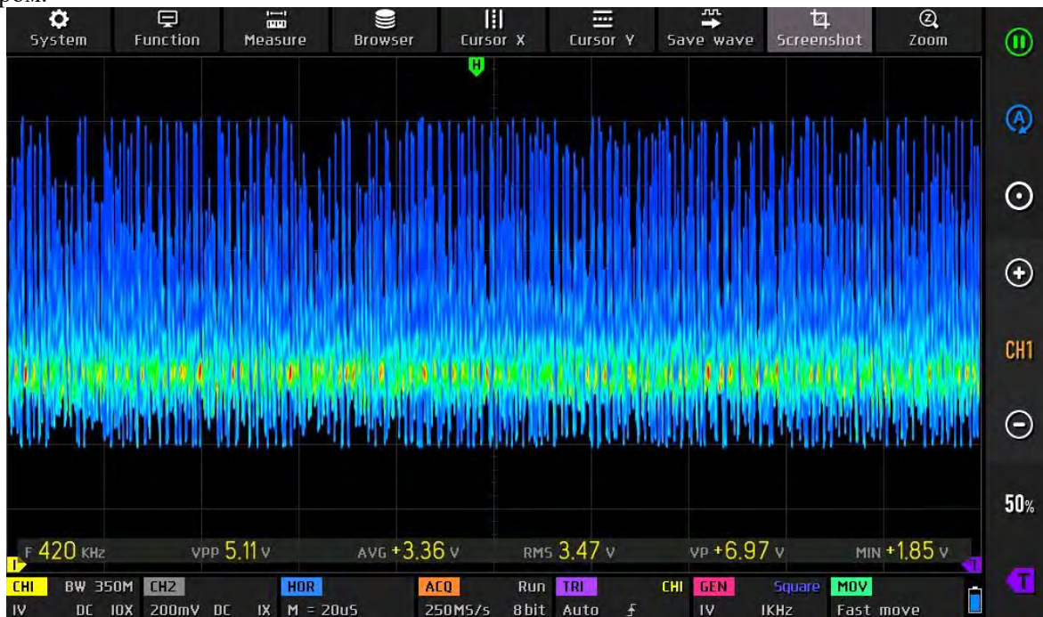
Рис. 1. Осцилограми оптико-електронного генератора детермінованого хаосу на основі біполярної транзисторної структури
