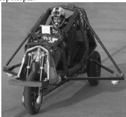
Рис. 3. Прототип дельта-моделі (вузький автомобіль з можливістю нахилу)
