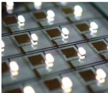
Рисунок 2 - Вигляд міні-світлодіодів, приєднаних до задньої панелі OTFT
