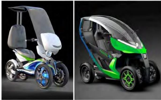
Рис. 5. Зразки вузького транспортного засобу, який нахилиється, розробленого в проєкті Resolve
