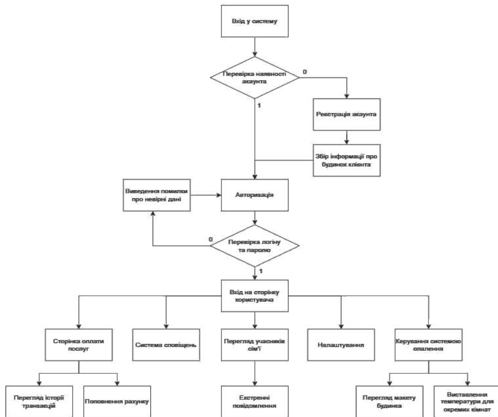
Рис. 1. Структура системи дистанційного керування системою опалення
