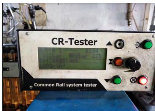
Рис. 1 – Прилад для перевірки форсунок Common Rail Tester
