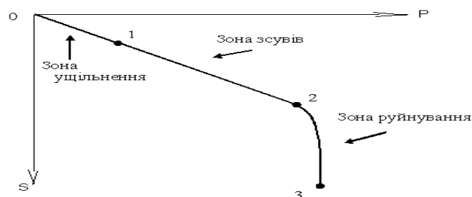
Рисунок 5 – Експериментальні дослідження залежності «осідання – навантаження» ґрунту
