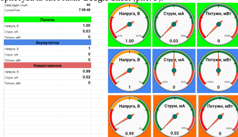
Рис. 3 – Графічний інтерфейс користувача інформаційно-вимірювальної системи
