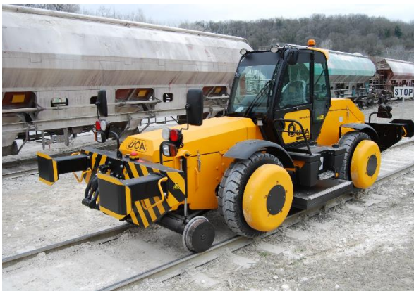
Рисунок 2 - Автомобіль на комбінованому ході UCA-TRAC B16
