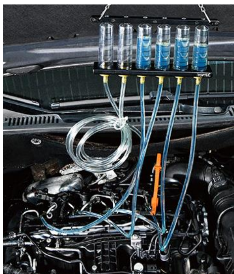
Рисунок 3 – Перевірка витрати палива через зворотню магістраль паливних форсунок.
