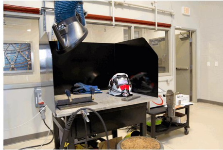
Рис. 2. Організація робочого місця зварника відповідно до європейських стандартів (витяжна вентиляція та захисні екрани) [4]
