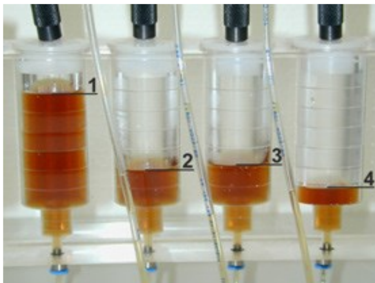
Рис. 5. Перевірка витрати палива через зворотну магістраль паливних форсунок
